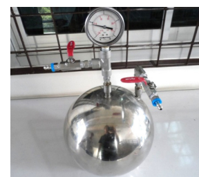
รูปที่ 2.4 ถังเก็บตัวอย่างอากาศชนิดอินทรีย์สารแบบใช้ภาวะสุญญากาศภายในถัง
