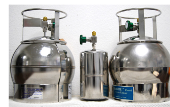
รูปที่ 2.2 ถังเก็บตัวอย่างอากาศชนิดอินทรีย์สาร (Summa Canister)
